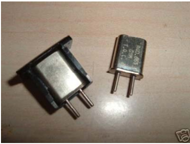
Fig. 4.14. Cristales usados en osciladores y filtros
