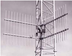
Fig. 10.46 Antena diédrica en polarización vertical.
