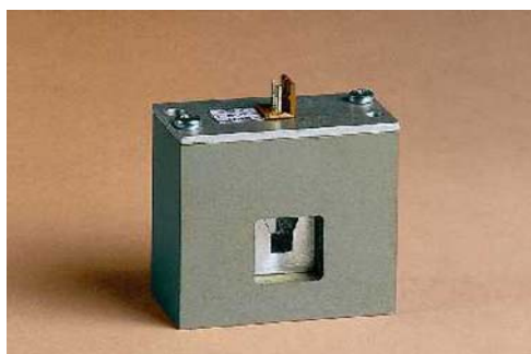
Fig. 4.19. Horno para oscilador a cristal
