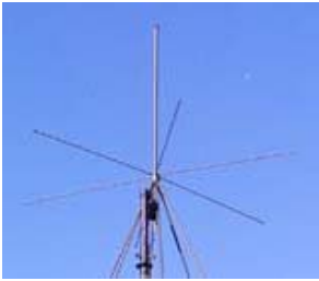
Fig. 10.31. Monopolo con plano reflector formado por varillas horizontales
