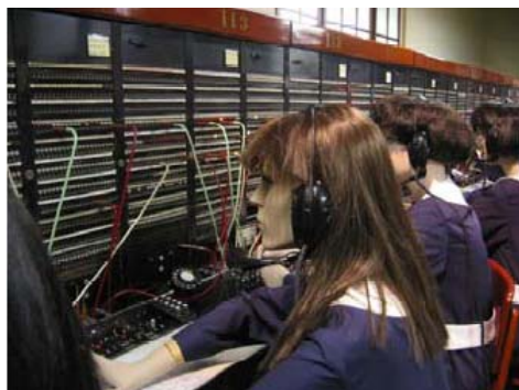
Fig. 1.14. Central telefónica manual
